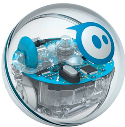
Obrázek 3: Robotická koule Sphero určená k edukačním účelům (Sphero: education, 2019)
